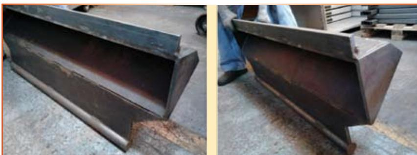
Fig. 9 – Ferramenta de dobramento para ponteira da catraca bloqueio
