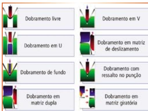
Fig. 1 – Tipos de dobramento em matrizes<sup>(2)</sup>
